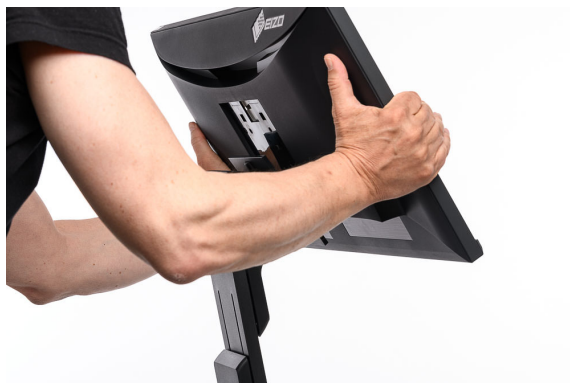
Takhle ne, prosím! Pro montáž na stojan je lepší displej bezpečně umístit na povrch.
