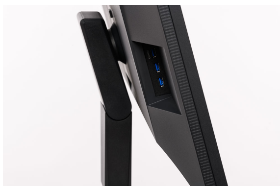
Navazující porty USB 3.0: V boční zásuvce jsou stále snadno přístupné
