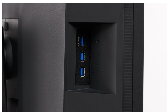
Navazující porty USB 3.0: Horní s funkcí nabíjení baterie
